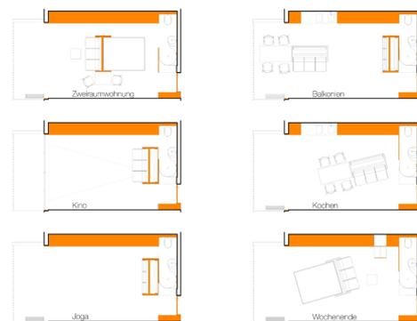
Abbildung 3: „Der Wandler“ von Cama A, Wandlungsmöglichkeiten des Einbauelements
