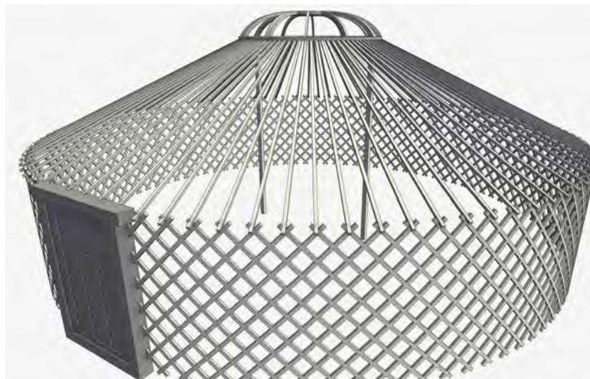
Abb.9: Fabian Felten und Philipp Herrmann, Isometrie der Skelettstruktur, www.pbb.architektur.uni-siegen.de (2021)
