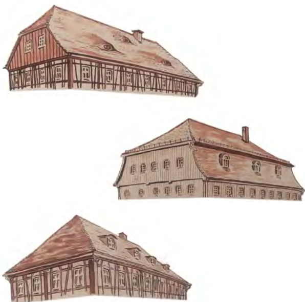
Abb 4: v.o.n.u.: Krüppelwalmdach, Mansarddach, Trapezdach
